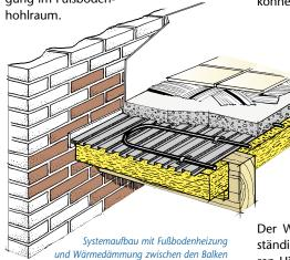
Das Holz der Unterkonstruktion kann weiter atmen, so dass das Faulen des Holzes und das Schaffen eines Nährbodens für Ungeziefer vermieden wird. Falls trotz der wasserbeständigen Ausführung der Fugen Wasser in den Fußboden-Hohlraum eindringen sollte, kann es nicht zu einer anhaltenden Schädigung kommen. Untersuchungen haben gezeigt, dass die natürliche Ventilation dafür sorgt, dass die Konstruktion nach höchstens drei bis vier Monaten wieder vollkommen trocken ist.
