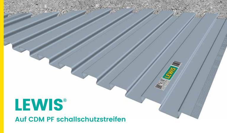
LEWIS® Schwalbenschwanzplatten sind bei der Herstellung schwalbenschwanzförmig gewalzten Stahlbleche, die zur Schalung und Bewehrung von dünnen Leichtgewicht-Betonböden auf Holz-, Stahl- oder sonstigen Trägerkonstruktionen verwendet werden. LEWIS® ist eine zuverlässige und professionelle Bodenlösung in Neubau- und Renovierungsprojekten.
